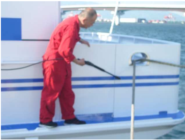
ウォーターコート施工
