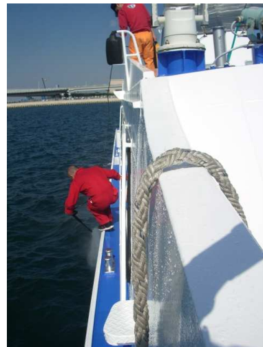
ウォーターコート施工
