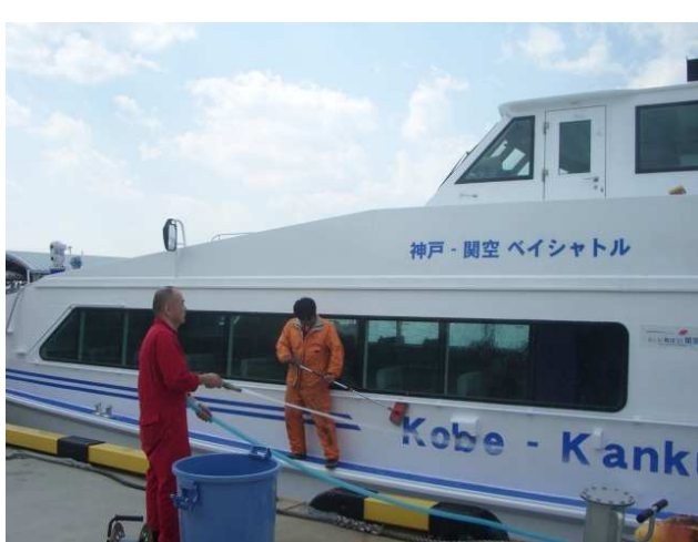
高圧洗浄機によりアルカリ洗剤を塗布後ブラッシング
